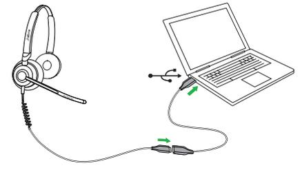
**Cómo usar el accesorio cable de extensión:** Solo tiene que conectar los auriculares al cable de extensión y el cable de extensión al puerto USB de su PC. Hay versiones del cable de extensión con USB-A y USB-C.
