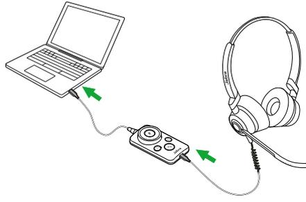
**Cómo usar el accesorio unidad de control:** Solo tiene que conectar los auriculares a la unidad de control y la unidad de control al PC. Hay versiones del controlador con USB-A y USB-C.
